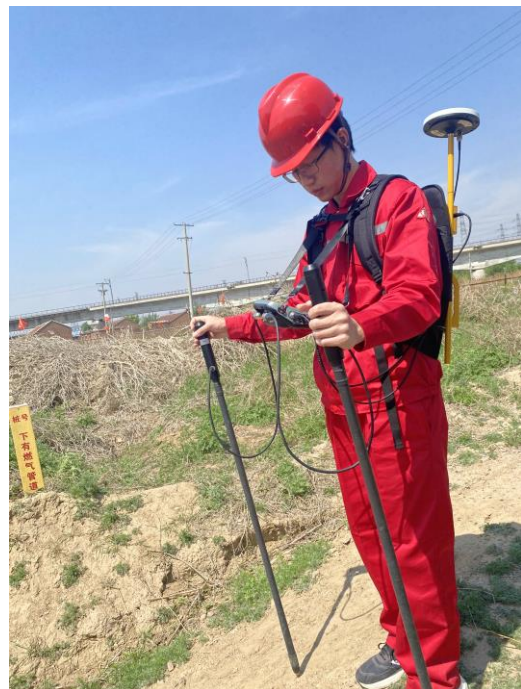
图 1 密间隔检测数据记录仪和工作图
